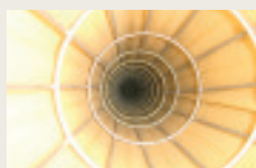
Aufnahme der Reingasseite eines P84 Filterschlauches nach mehrjährigem Einsatz
